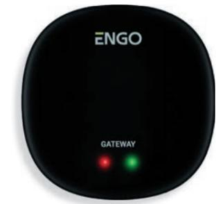
Шлюз является главным компонентом системы управления домом через Интернет на основе протокола передачи данных ZigBee 3.0. Подключается к Интернету через Wi-Fi-роутер. Собирает данные с устройств, работающих в сети, и позволяет реализовать правила/сценарии, созданные в приложении ENGO Smart. Поддерживает их даже при отсутствии доступа к Интернету.
