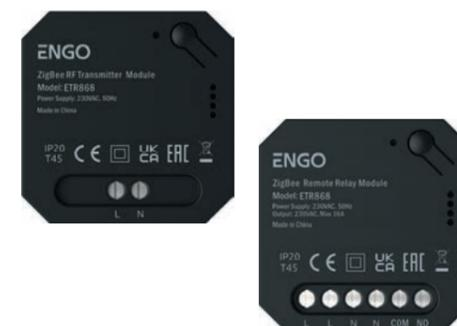
Комплект используется для беспроводной связи электроприборов (таких как насосы, вентиляторы, освещение, электронагреватели, бойлеры и т.д.). Решение идеально при отсутствии проводки между электроприборами. Передатчик (ETR-868TX) и приемник (ETR-868RX) сопряжены на заводе.
