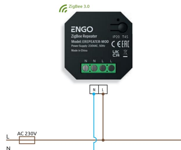
ОПИСАНИЕ КЛЕММ ПОДКЛЮЧЕНИЯ РЕПИТЕРА ZIGBEE
