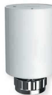
Беспроводной привод для управления радиаторным отоплением. Для корректной работы необходимо связать его с терморегулятором E25 по беспроводной связи 868 МГц. К одному терморегулятору можно подключить 6 приводов ETRV. Используя интернет-шлюз, можно управлять комплектом (сервопривод + терморегулятор) удаленно с помощью приложения ENGO Smart.
