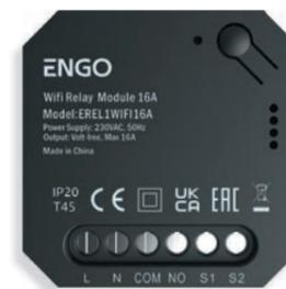
Данное реле может по беспроводной связи управлять выбранными устройствами в умном доме: котлом, циркуляционным насосом, вентиляторами, освещением, воротами, электронагревателями и т. д. Имеет возможность подключения датчика EFS300, показания которого (в приложении) позволяют создавать правила на основе полученных измерений, например поддерживать температуру электрического и водяного пола.
