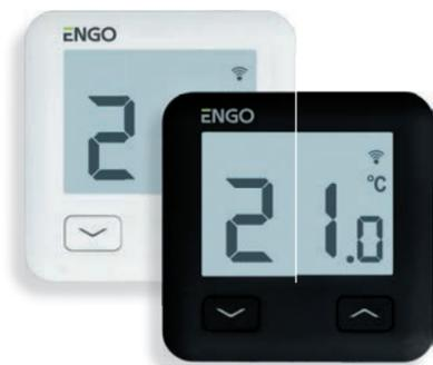
Терморегулятор тёплого пола/воздуха с возможностью подключения датчика тёплого пола. Контролирует климат помещения с использованием новейших технологий. Питание 220 В, скрытый монтаж. Программируется и управляется в приложении ENGO Smart. Работает только с нормально закрытыми приводами.
