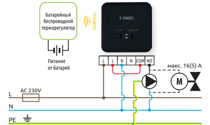
с) Схема подключения к центру коммутации
